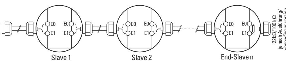
Slave-Elektroden für Reihenschaltung = Slave 1, 2, ..usw.
