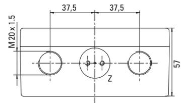
Alle Gewinde und Bohrungen in Wand A
